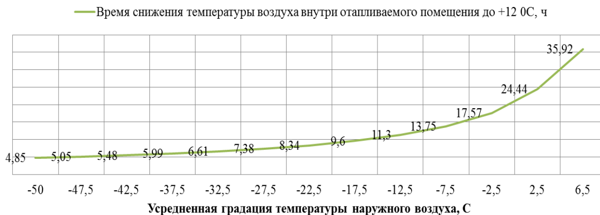
Рисунок 9-1. График зависимости времени падения температуры внутри помещений от температуры наружного воздуха
